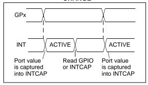
FIGURE 3-9: INTERRUPT-ON-CHANGE FROM REGISTER DEFAULT
